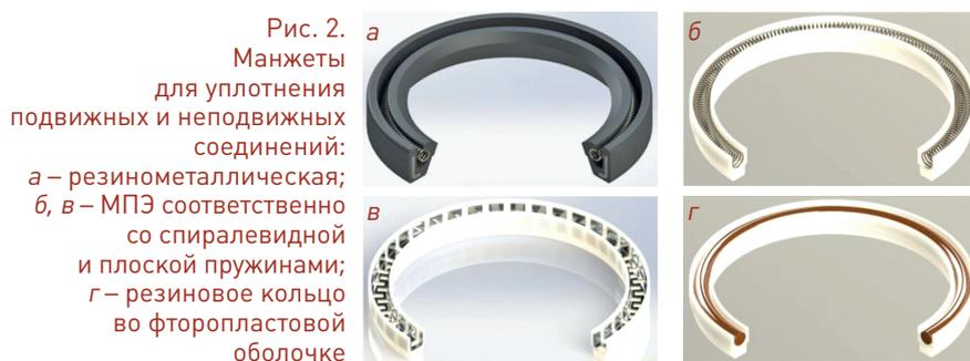
Рис. 2. Манжеты для уплотнения подвижных и неподвижных соединений: а – резинометаллическая; б, в – МПЭ соответственно со спиралевидной и плоской пружинами; г – резиновое кольцо во фторопластовой оболочке
